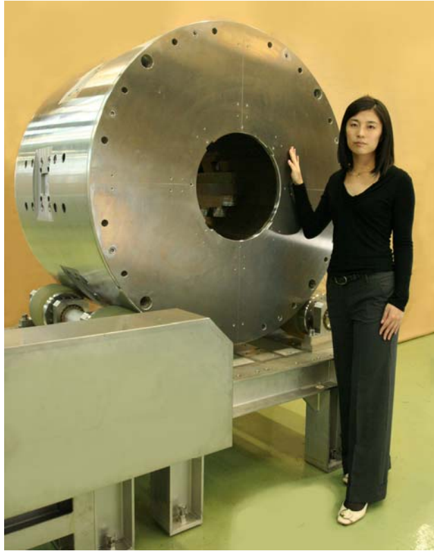
(上・写真) 信越化学が開発した世界最大級の永久磁石式磁気回路 (強磁場ハルバック型磁気回路)
