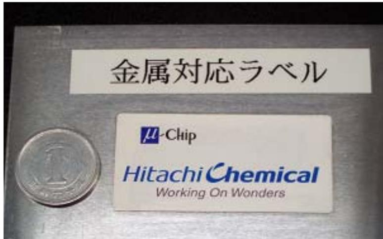
= 金属対応ミューチップ RFID ラベル試作品 (縦 2.5 センチメートル×横 5 センチメートル×厚さ 0.5 ミリメートル) =
