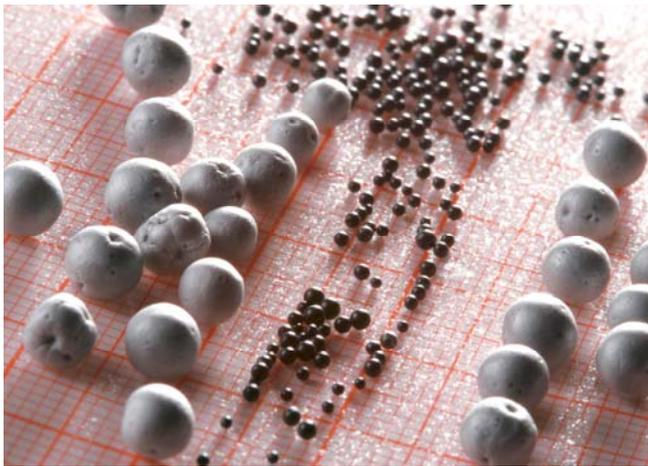
写真:発泡性のあるポリスチレン粒子(中央)は、BASF の顧客が発泡し、断熱パネルや各種成形部品に加工して、建物の外壁、天井、床などの断熱に使用します。
