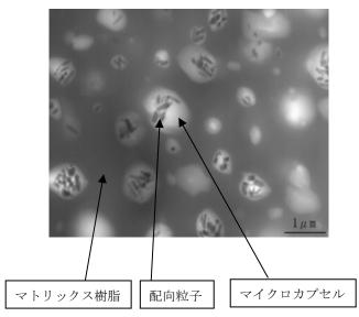
上:電圧印加時、粒子が配向し、透明に。
