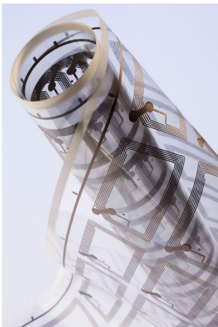
BASF の IC タグ用フレキシブルアンテナ基板向けの金属インク
