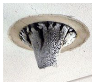
⇒ 中間層に配合した特殊無機物により遮熱性を確保
