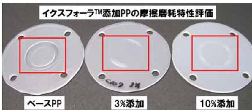
※磨耗試験にて、ベース PP は中央に円形の溝が切れているが、イクスフォーラを添加したPPでは溝が切れていない。 以上
