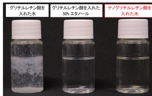
グリチルレチン酸は水に溶解しない(左)。従来は 50%エタノールに溶解していた(中)。今回開発した「ナノグリチルレチン酸」は、80 ナノメートルサイズで安定的に分散されているため、光が透過して透明に見える(右)。
