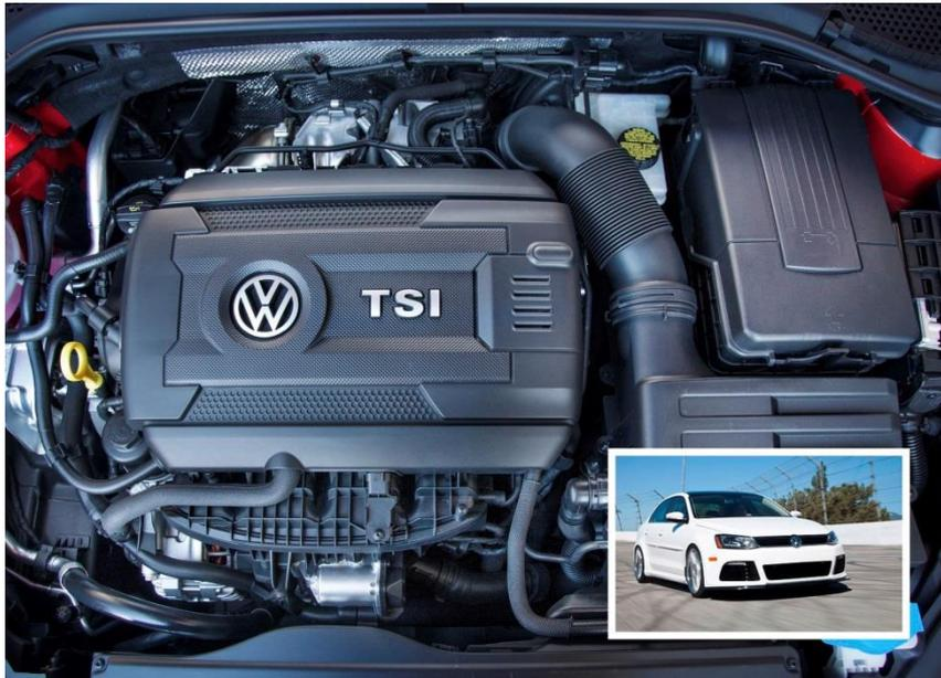
フォルクスワーゲン社のエンジンカバーの吸音材として採用された、BASF の吸音材・メラミン樹脂発泡品 Basotect® TG。北米で生産されているフォルクスワーゲン社のジェッタ、ゴルフ、パサート、ティグアン、ビートルの EA888 型エンジンの吸音層に採用されています。
