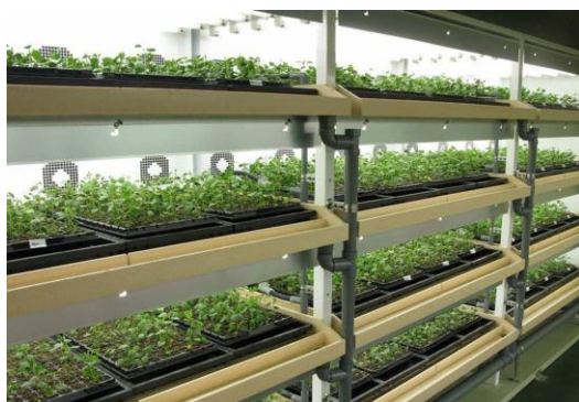
人工光閉鎖型苗生産設備
