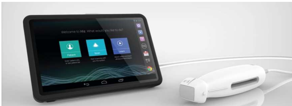
「SonoSite iViz」は、画面サイズ 7 インチの本体とセクタプローブで構成
