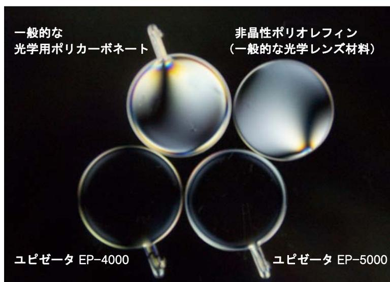
【写真】複屈折の比較（射出成型板の直交ニコル下での光漏れ）
