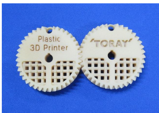
真球ポリアミド6粒子を用いた3D造形物(サンプル)
