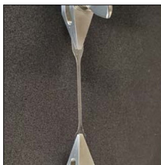
(図 4)AI 予測を行い作製したフレキシブル透明フィルム(引張試験中の写真)
