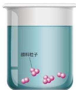
<顔料粒子が凝集して沈んだ状態>
