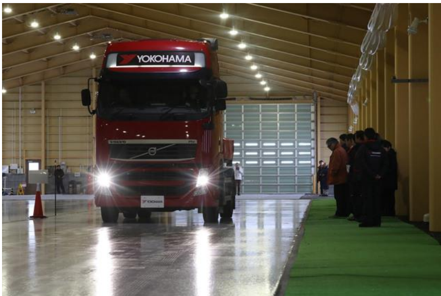
冷媒装置を導入した屋内氷盤試験場での走行テスト（イメージ）
