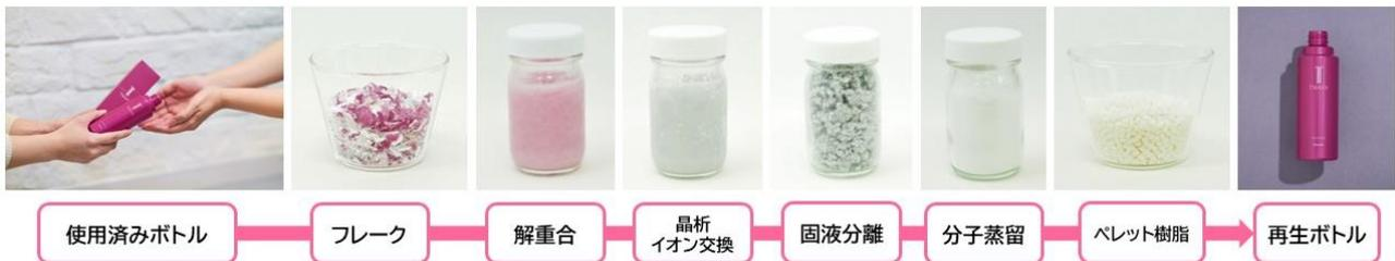
回収後の使用済みボトルが、ケミカルリサイクルにより水平リサイクルされ、再び化粧品ボトルになるまでの流れ
