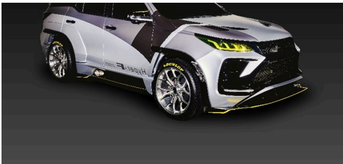
TAFNEX®CF/PPおよび3Dプリンティング部品が搭載されたTOYOTA Hyper-F CONCEPT
