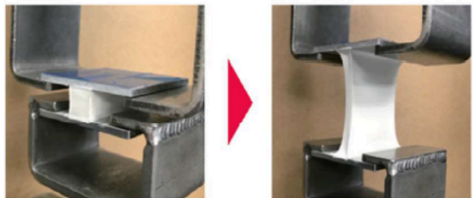
引張接着試験の様子
