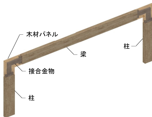
図-2 本工法を用いたラーメン構造の概要
