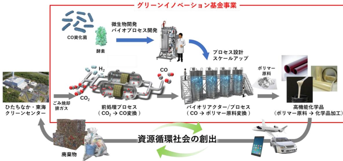
CO<sub>2</sub>→CO 変換の前処理プロセスと CO→ポリマー原料変換のバイオリアクター/プロセス
