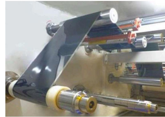
ロール・ツー・ロール製造プロセス(※) (提供:積水化学)
