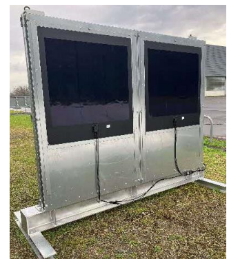
ペロブスカイト太陽電池付き 防音壁（試作品）
