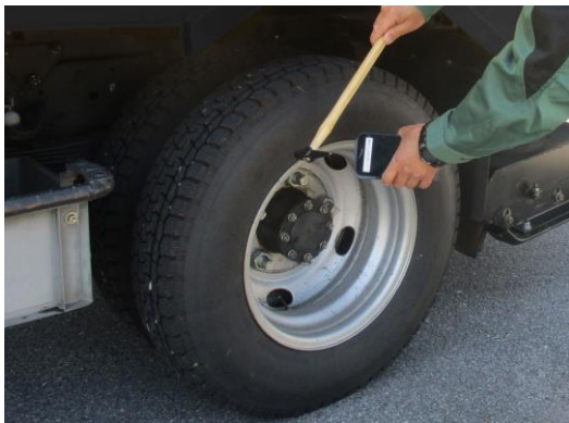
専用アプリを使った空気圧点検の様子
