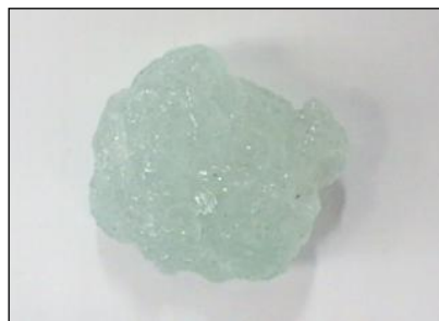
ラボ設備で試作したブタジエンゴム
