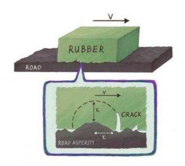
凹凸路面上を滑るゴムの摩耗プロセス
