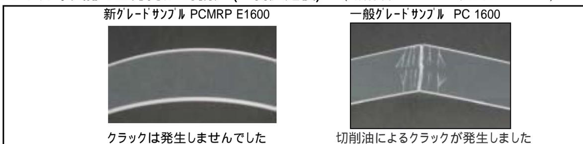
新グレードは、代表的な油やパッキン類を使用し、14日間の応力下促進試験結果から、クラック発生などの外観変化がないことを確認しておりますが、ご利用いただく際はご使用になる油脂類やパッキン類を用い、使用条件での耐性を必ずご確認ください。
